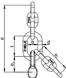
Die Güteklasse 8 Verkürzungseinheiten für verwechslungsfreie Aufhängeköpfe TWN 0896 werden in Kettengehängen eingesetzt und ermöglichen die Anpassung der Stranglängen an die Einsatzbedingungen. Die Herstellungs- und Prüfanforderungen basieren auf der DIN EN 818-4, DIN EN 1677 Teile 1 und 4 sowie DIN 5688-3.
